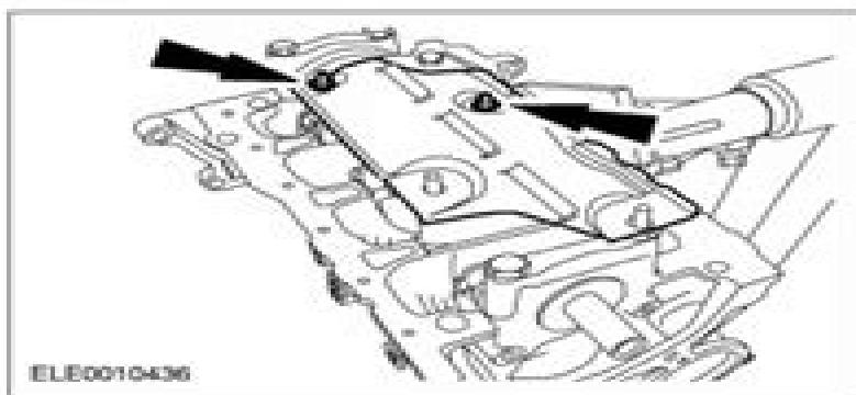
**33. NOTA:** No dañe las camisas de los cilindros. Guarde las tapas, los casquillos de cojinete y las bieles en orden para facilitar el montaje.
